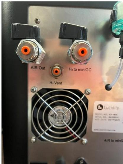
Las líneas de conexión deben conectarse a la toma de corriente adecuada. Lucidity GC-FID y Lucidity GAS tienen puertos etiquetados para una conexión adecuada.
