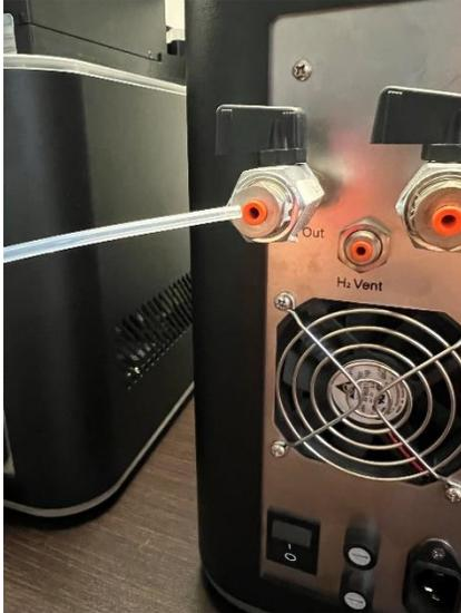
Los puertos de conexión en la parte posterior del Lucidity GAS son conexiones a presión. Inserte la línea adecuada en el puerto adecuado (etiquetado correctamente) y empuje hasta que quede asegurado.
