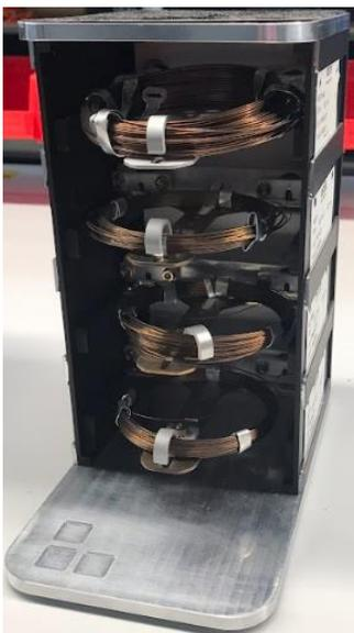
Rack de almacenamiento de columnas que contiene hasta 4 columnas
